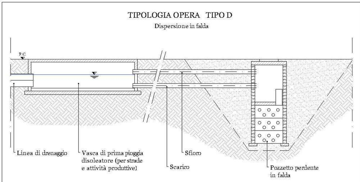
Alle tecniche sopra esposte si possono aggiungere altri accorgimenti tecnici che possono aumentare i volumi idrici che si infiltrano, o aumentare il tempo di detenzione prima della restituzione alla rete scolante. Di seguito si riportano tre esempi.
