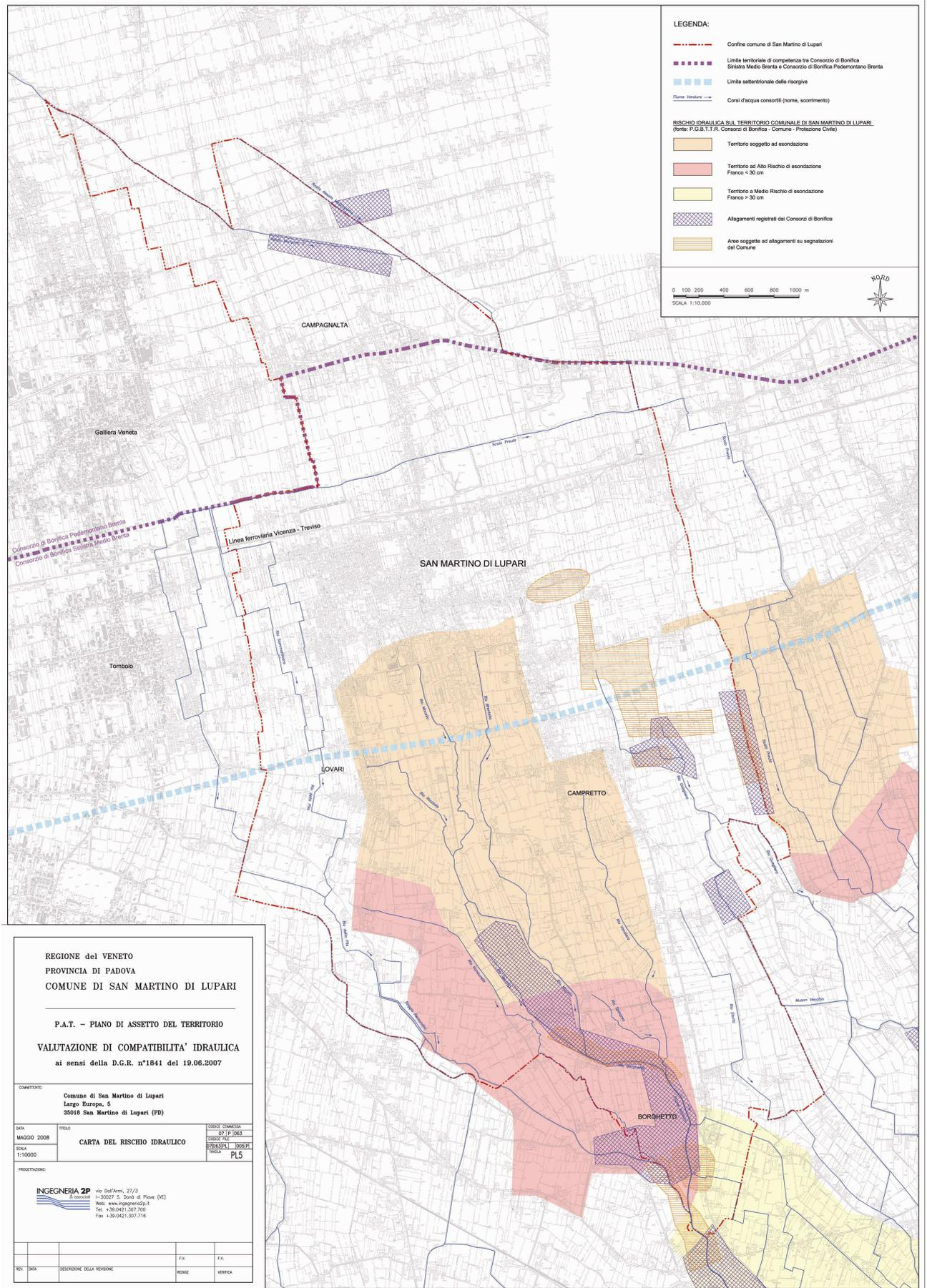
Figura 5.12: elaborato B.3.5 “Carta del rischio idraulico” della V.C.I. del P.A.T. del Comune di San Martino di Lupari.
