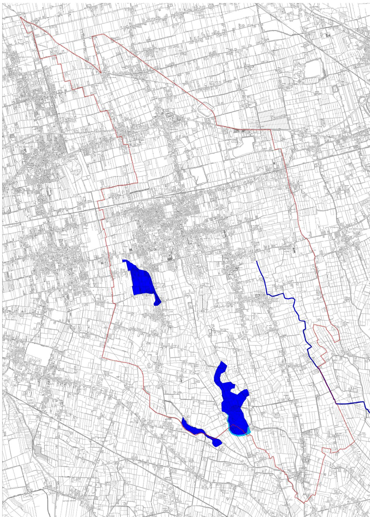
**Figura 5.5:** estratto della “Carta della pericolosità idraulica” (PER-72-CTR e PER-63-CTR) del Piano di Assetto Idrogeologico (P.A.I.) del Bacino Idrografico scolante nella Laguna di Venezia (in blu le aree P2 a pericolosità media e in azzurro le aree P1 a pericolosità moderata).
